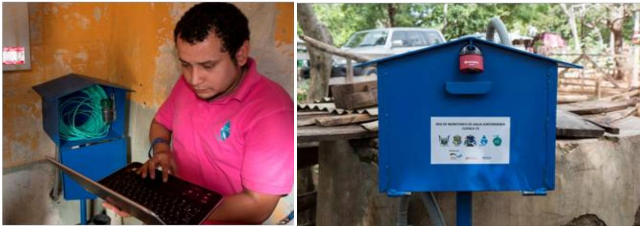
Foto 10. Izquierda: delegado de la ANA para la Cuenca 72 realizando descarga de datos vía bluetooth. Foto 11. Derecha: Caseta de seguridad para protección del equipo de monitoreo (sensor de medición de nivel de agua subterránea).
