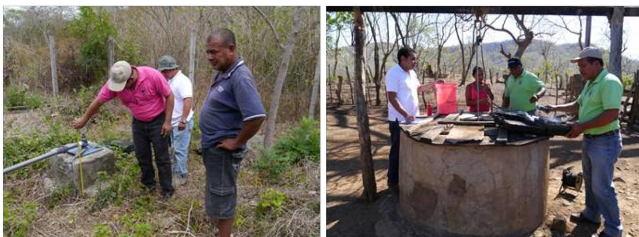
Foto 8: Izquierda, Técnico municipal de San Juan del Sur midiendo base de concreto de un pozo excavado. Foto 9: Derecha, Técnicos municipales de San Juan del Sur con el delegado de la ANA para la Cuenca 72 midiendo parámetros físico químicos en un pozo excavado.
