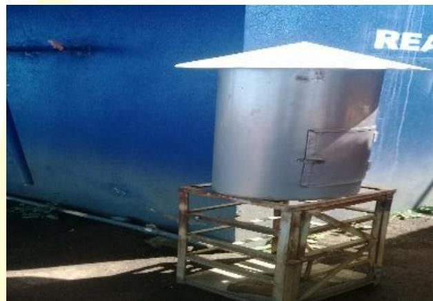
Imagen 4. Chimenea quemadora de gases
